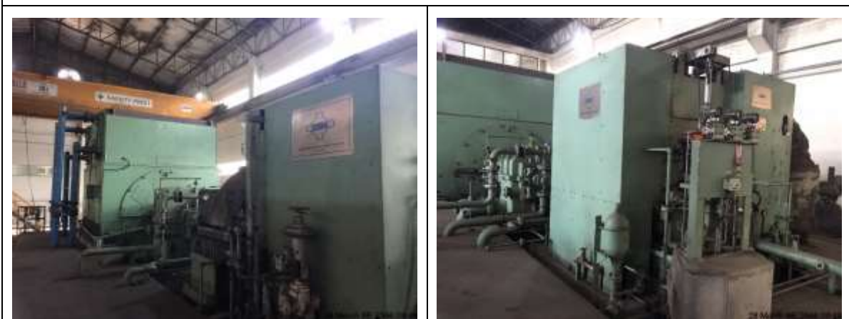
รูปที่ 19 การปิดครอบเครื่องจักรอุปกรณ์ที่มีเสียงดัง
